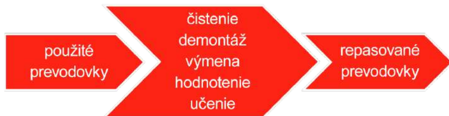
obrázok 37: postup pri obnove použitej prevodovky
