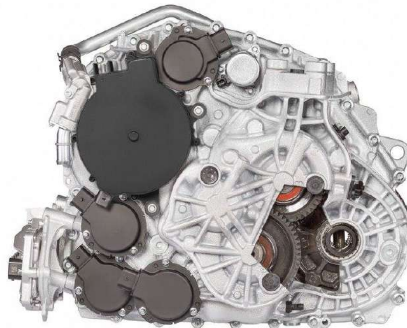
obrázok 9: hybridná dvojspojková prevodovka 7HDT300 48V
