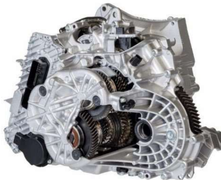
obrázok 8: 7-stupňová dvojspojková prevodovka 7DCT300 so systémom Smart Actuation
